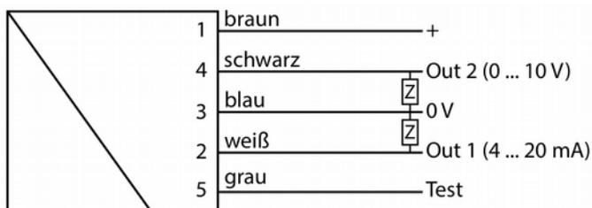
**Achtung:** Pin 5 darf nicht elektrisch kontaktiert werden! Idealerweise benutzen Sie ein 4 poliges Kabel. Der SU20 darf nicht vom Grundgerät gelöst werden.
