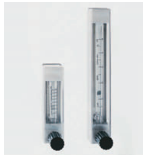
Ein beweglicher Schwebekörper in einem transparenten Messrohr mit Skaleneinteilung zeigt anhand seiner Stellung das Durchflussvolumen an.
